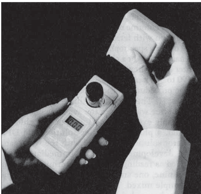
شكل 2-15: مقياس لوني يعمل على البطارية لقياس متبقيات الكلور الحر والكلي في عينات مياه صافٍ بواسطة طريقة DPD (موافقة Hack Co Loveland, Co)
